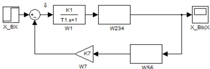
Эквивалентная ПФ разомкнутой системы определяется как произведение ПФ всех звеньев, последовательно включённых в замкнутый контур:
