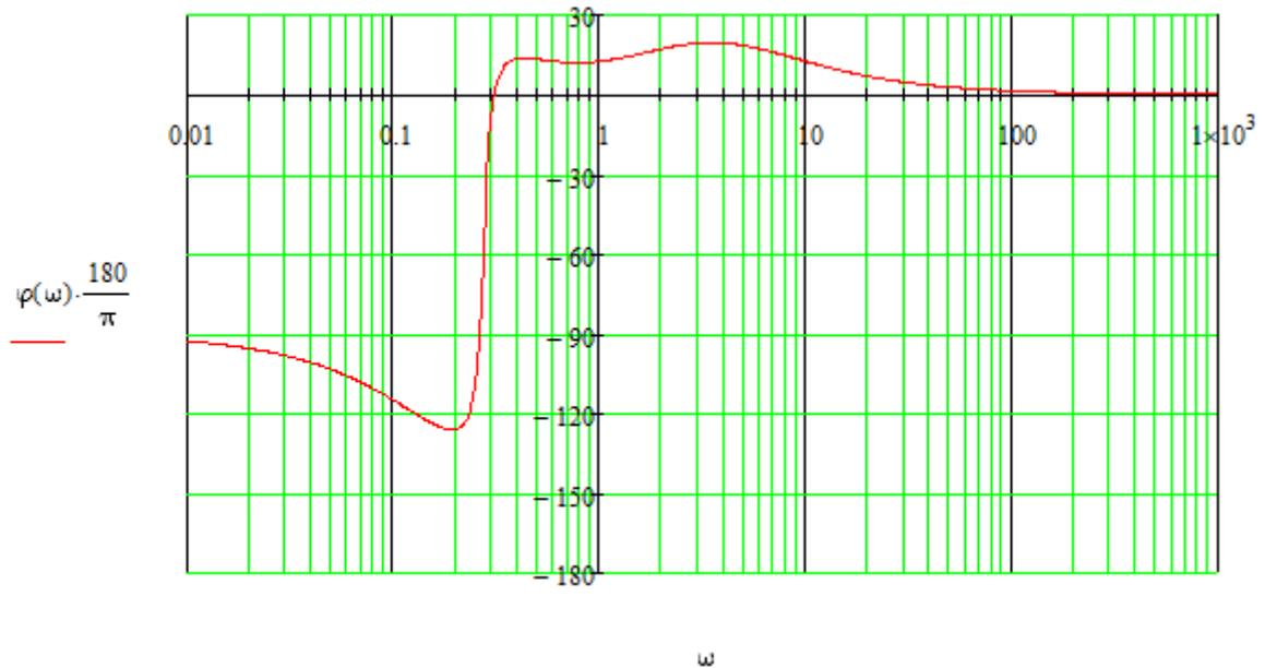
Определяем, что ЛФЧХ не опускается ниже уровня  $-180^\circ$ , следовательно, замкнутая система будет устойчива при любых положительных коэффициентах передачи.
