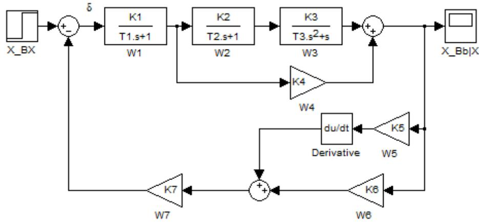
Эквивалентная ПФ последовательно соединённых звеньев W2 и W3 соединена параллельно со звеном W4. Эквивалентная ПФ данного контура:
