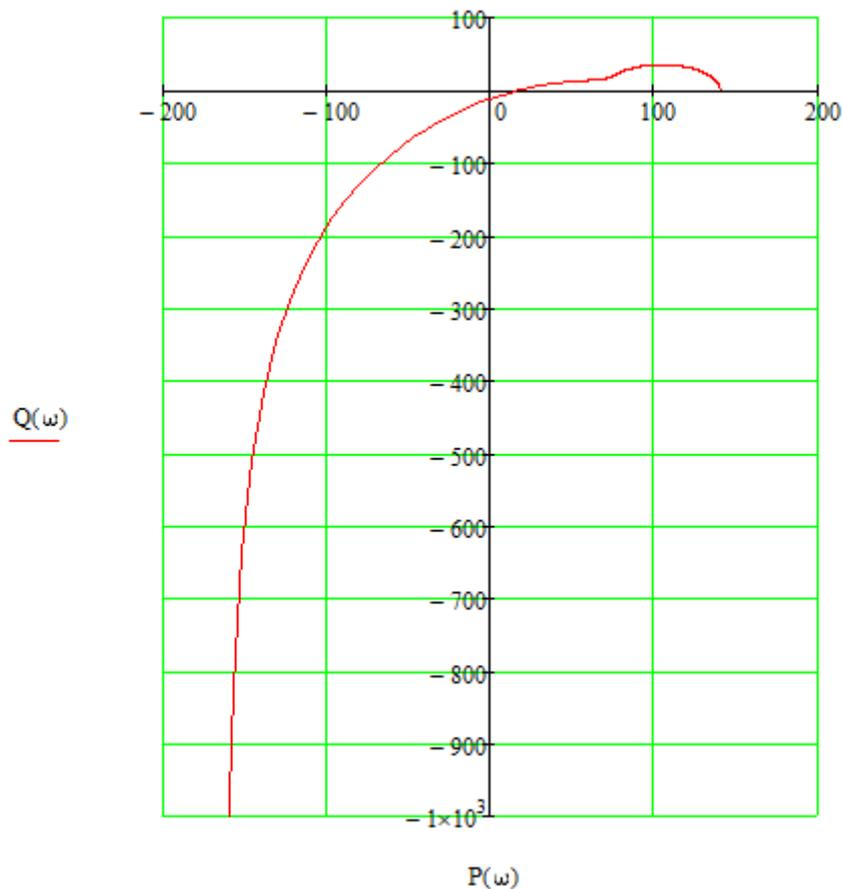
Определяем, что годограф не охватывает точку  $(-1; j0)$ , следовательно, замкнутая система устойчива.
